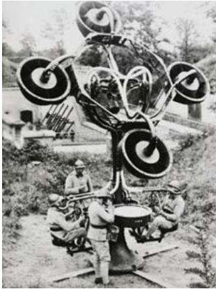
Systemes de détection acoustique du réseau d'alerte aux bombardements à Paris.
